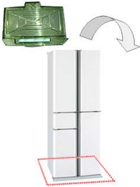
冷蔵庫ドレンパン
