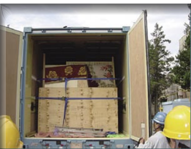
荷崩れしやすい段ボール容器は、輸送中に製品が動かないようにベルトで固定。
