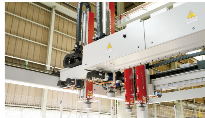
国内初の導入となる「ASTES4 SORT」は、4つのアームで材料の仕分けから加工完了品のピックアップ、端材の搬出まで難なくこなす。多田社長が一目惚れした一品。
