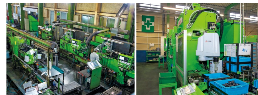
左は本社工場、右は富田工場、ともに自動車用量産部品を製造する。長年にわたり三菱電機製CNCを採用いただいているほか、富田工場では最終加工された部品の自動検査で三菱電機製ロボット「MELFA RH-6FHM-D」が活躍している。
