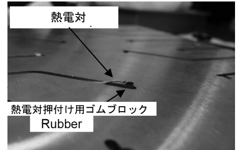
図3. 熱電対取付け例(ヒートシンク表面)
