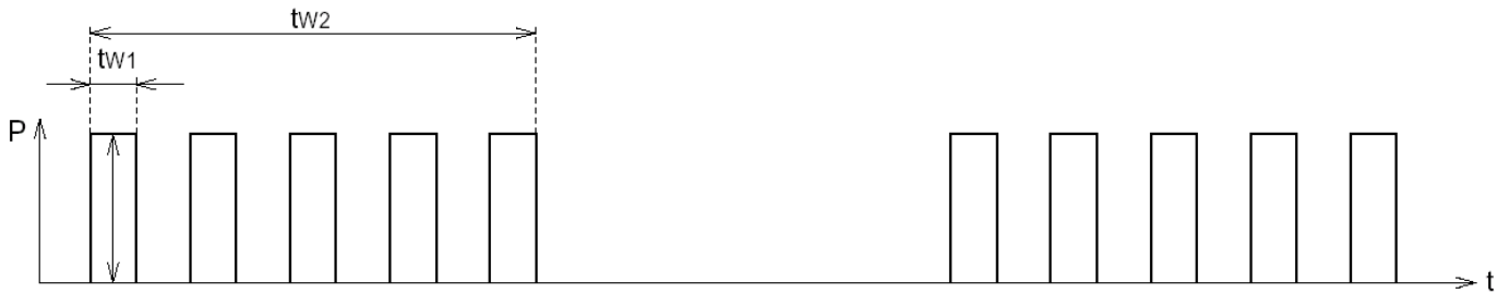
図 10-4. 平均パワー損失の考え方 1
