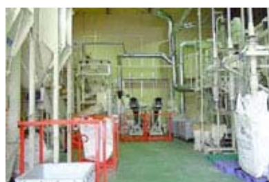
微破碎設備 プラスチック部品は最終的に直径10mm程度に 微破碎され、不純物を取り除いた後、再生原料 としてGCSIに出荷される
