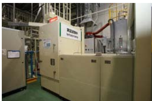
臭素含有プラスチック除去装置 (X線分析選別装置)
