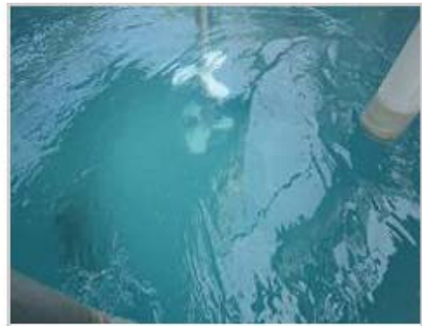
MF膜を使って無害化処理した水。 更にRO膜装置で溶解性塩類などの 不純物を取り除いた後、めっき工場で 再度洗浄に使用する。
