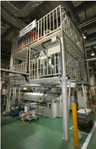
リペレット装置(再生した高純度なプラスチックをペレット化する装置)
