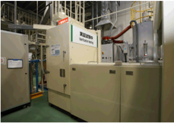
臭素含有プラスチック除去装置(X線分析選別装置:実証試験中)
