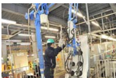
冷蔵庫の解体ライン 立てたまま解体作業ができるのは画期的で、 スペース効率も飛躍的に高めた
