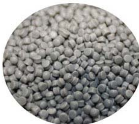
GCSが製造した「再生プラスチック」 これを製品(素材)として、三菱電機に供給します。
