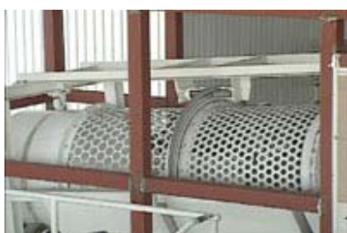
分級装置 機械破碎でできた破砕片を分級装置によって大 きさを3つに分類することで選別効率を高めてい る
