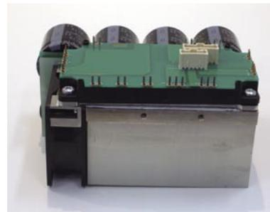
SiCパワーデバイスを用いた11kWインバーター
