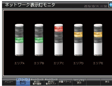
【モニタ画面】 ネットワーク監視表示灯の動作状況をランプ表示で確認できます。
