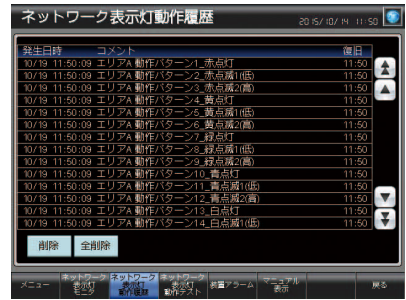
【動作履歴画面】 ネットワーク監視表示灯の動作履歴をメッセージで確認できます。
