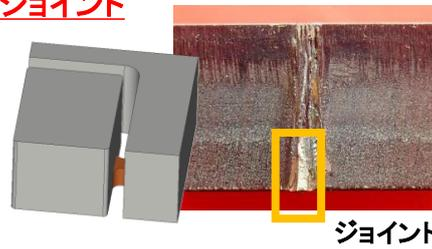
ジョイント部が弱い出力で加工されることで、ワークの下部が薄くつながって残っているため、外しやすいです。(ライトジョイントに対応した加工機で有効です。)
