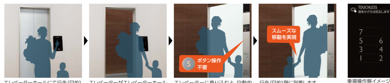
エレベーターホールにて行先(目的)階に登録します。エレベーターがエレベーターホールに到着します。エレベーターに乗り込むと、自動的に行先(目的)階に登録されます。行先(目的)階に到着します。乗場操作盤イメージ
