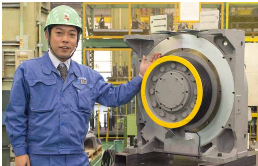
従来機に比べ大幅な小型軽量化(体積比:65%、重量:70%)に成功した新型巻上機。大容量化の要ともいえる部分だ。
