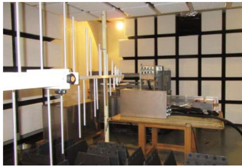
鎌倉製作所に電気系のシステムを持ち込み、入念な耐電磁波試験を実施
