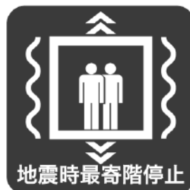
図2 P波感知型地震時管制運転装置
