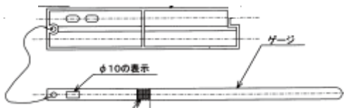
E：綱車溝摩耗確認治具
