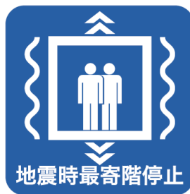
図 2.6.2 P波感知型 地震時管制運転装置
