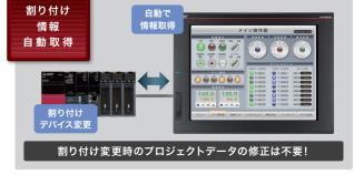
グローバルラベルを用いて画面を作成した場合は、GOTが自動で割り付け情報を取得するため、デバイスの割り付けを変更してもプロジェクトデータの修正・転送は不要です。
