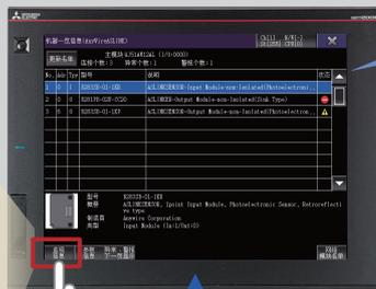
将支持iQSS的机器的内容进行显示，可确认传感器的型号、异常发生状态等。
