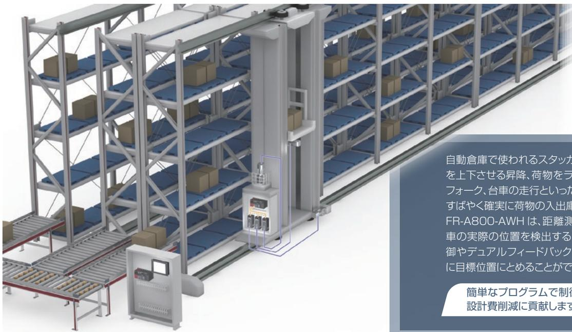
自動倉庫で使われるスタッククレーンは、荷台を上下させる昇降、荷物をラックに受け渡すフォーク、台車の走行といった3軸を制御して、すばやく確実に荷物の入出庫を行います。FR-A800-AWHは、距離測定器を用いて台車の実際の位置を検出するフルクロード制御やデュアルフィードバック制御で、常に正確に目標位置にとめることができます。
