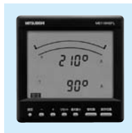
位相角表示 P1端子とP2端子の 結線が逆の場合
