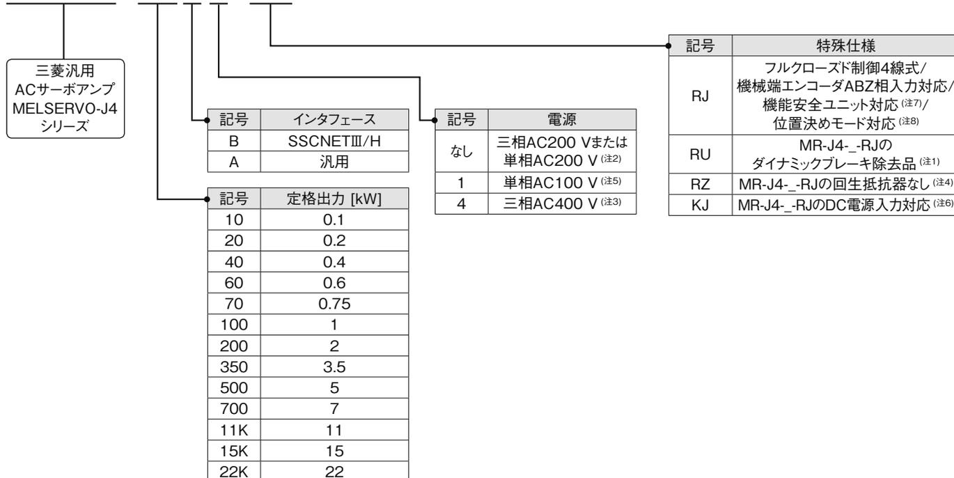
注) 1. 7 kW以下のサーボアンプに内蔵されているダイナミックブレーキが除去されたタイプです。ダイナミックブレーキ除去品使用時は、アラーム発生時や電源遮断時にサーボモータが急停止しません。装置全体で安全を確保してください。
