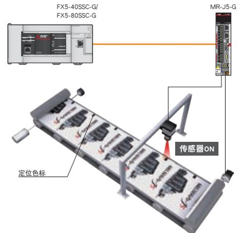
在检测到对伺服放大器的触发输入信号时锁定任意数据的功能。根据锁存数据计算出补偿量，并用于补偿辅助轴。
