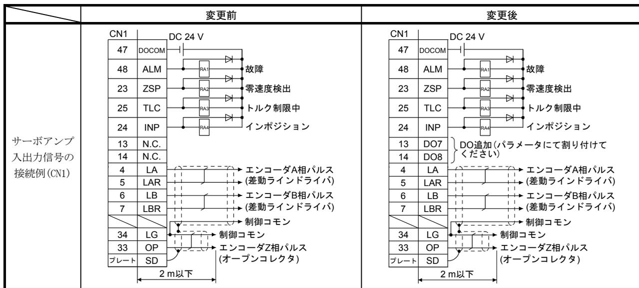
図1. 汎用出力信号インタフェース追加(シンク出力の例)
