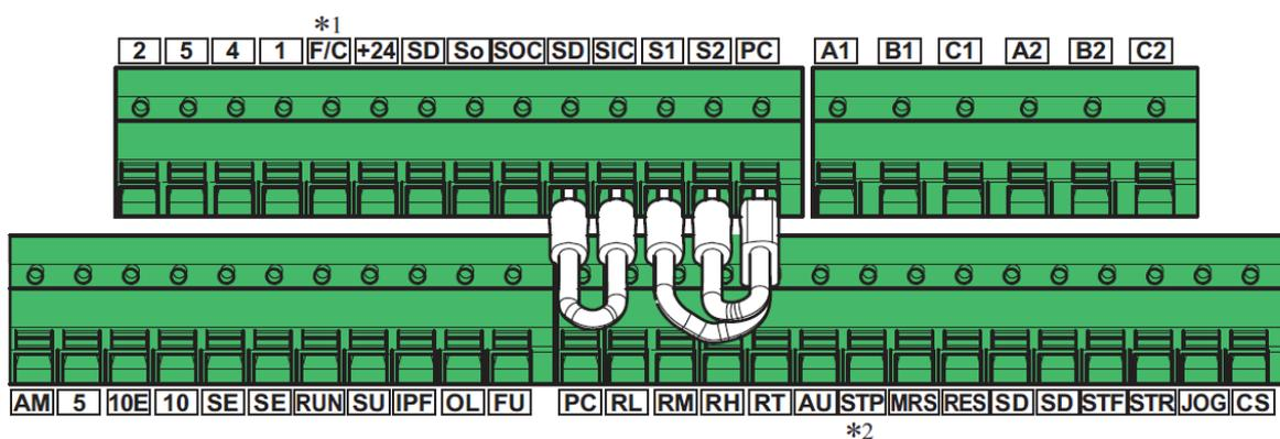
\*1) FM タイプインバータでは端子 FM として機能します。CA タイプインバータでは端子 CA として動作します。
