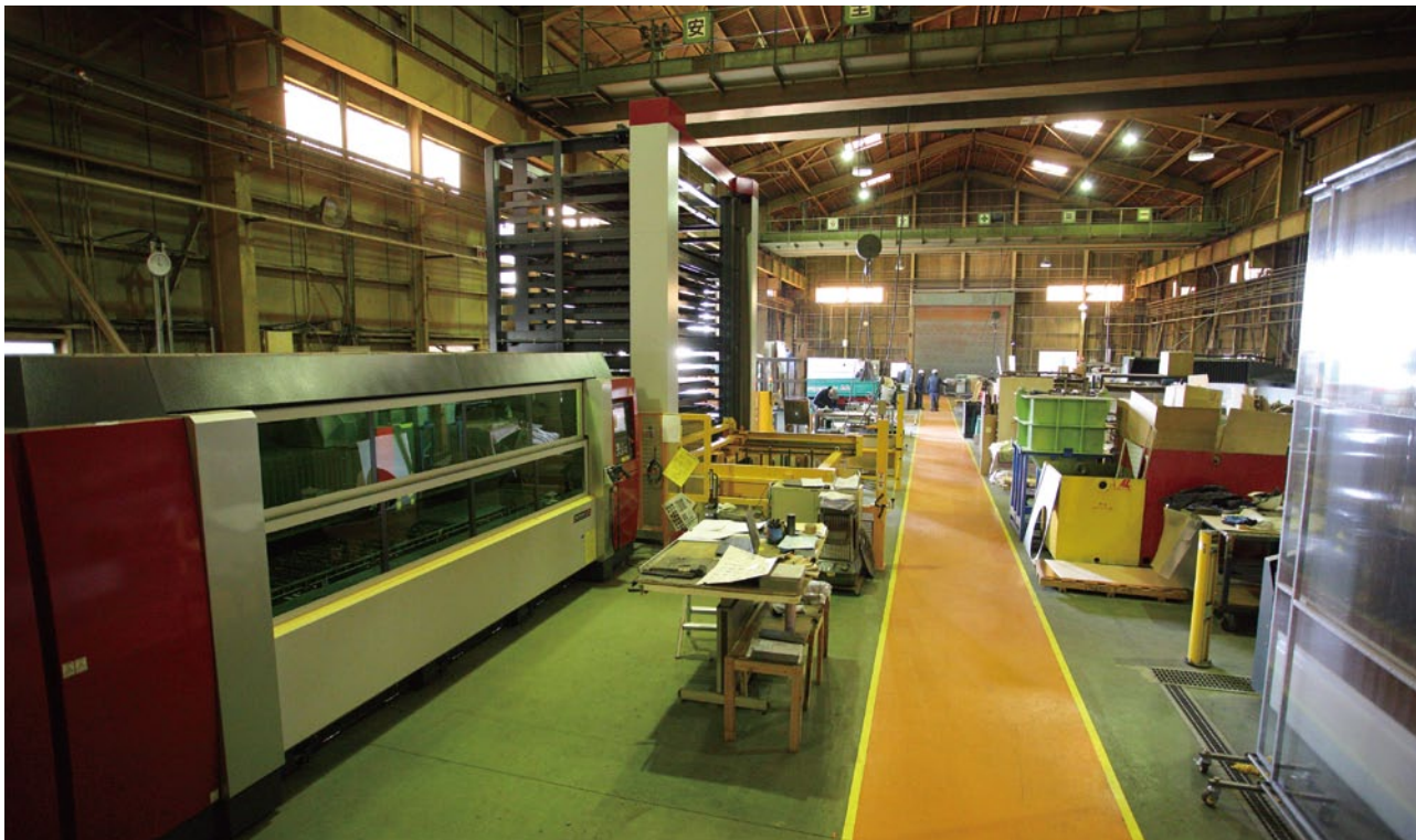
鉄・非鉄・非金属の加工を担当する第一カンパニーの工場。3台のレーザー加工機のほか、ウォータージェット加工機も稼働している。
