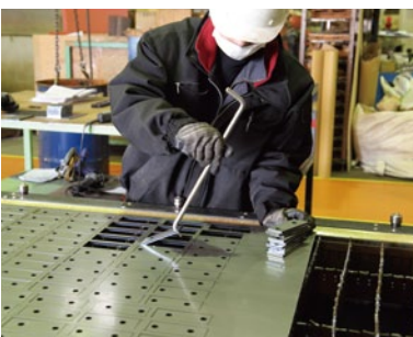
加工が終了したワークを銅板から外していく。同社は「ML3015eX-F60」で厚さ3.2～16mmの銅板を加工する。厚さ25mmまで可能だという。
