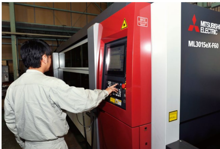
2017年7月に導入した三菱電機の6kWファイバレーザ加工機「ML3015eX-F60」。
