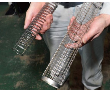
「ML3015eX-F60」で加工し、溶接して完成させた省人・省力化機器の部品。
