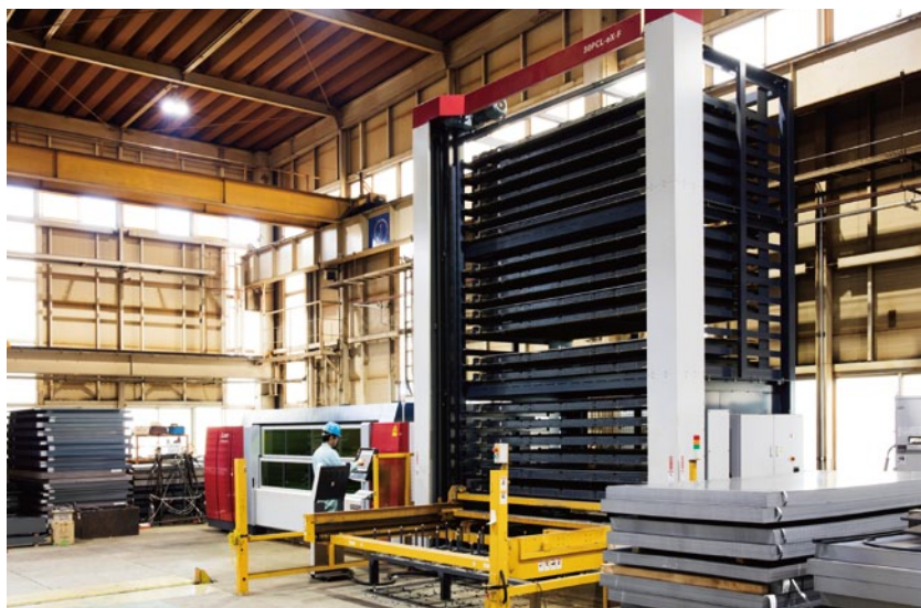
ファイバレーザ加工機は20段のパレットチェンジャを搭載している。稼働率を極限まで高めるために特注したレーザー自動化システムだ。
