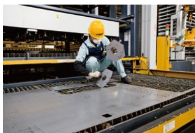
加工が終了したワークを鋼板から外していく。6kWファイバレーザでは、厚さ25mmまでの鋼板を加工している。
