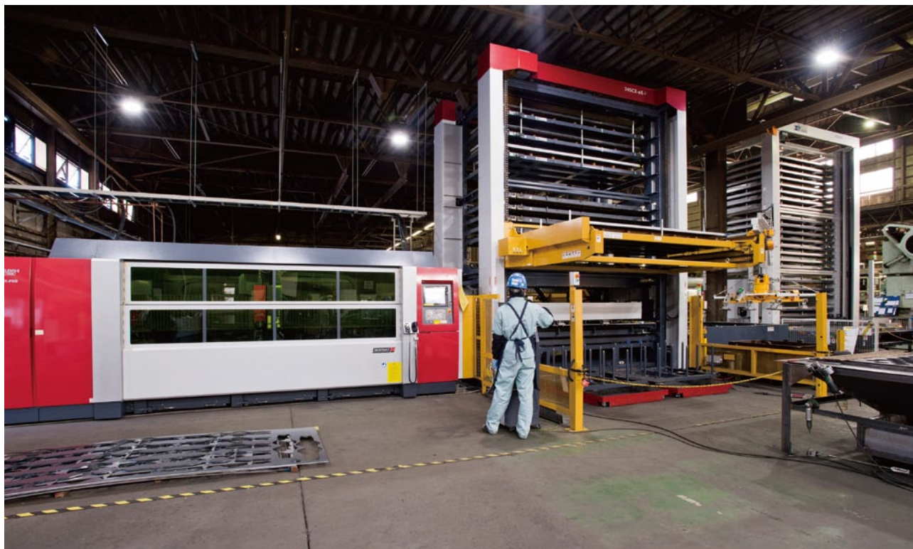
「ML3015eX-F60」と一緒にストックシステム(写真中央)と24段の素材棚(右端)も導入した。ストックシステムは素材をレーザー加工機に自動供給し、加工が終了した製品を加工機から自動搬出。ストックシステムの素材は材料棚からハンディーローダで供給される。
