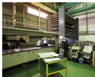
2001年に導入した三菱電機の3.5kW CO 2 レーザ加工機「ML3015LZP」。すでに17年も使い続けているが、いまだに現役だ。
