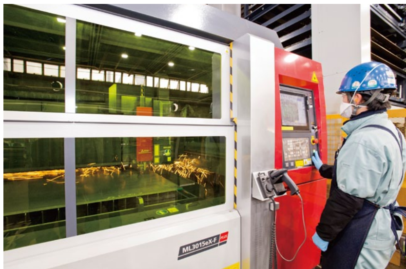
2017年6月に導入した三菱電機の6kWファイバレーザ加工機「ML3015eX-F60」。CO 2 レーザ加工機に比べるとランニングコストは80%も削減できた。
