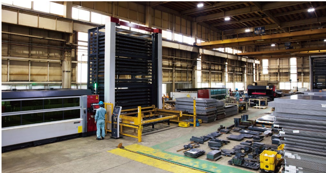
河合シャーリングの第1工場。レーザー加工機6台とシャーリング機械が稼働している。熔断は別棟の第2工場で行う。
