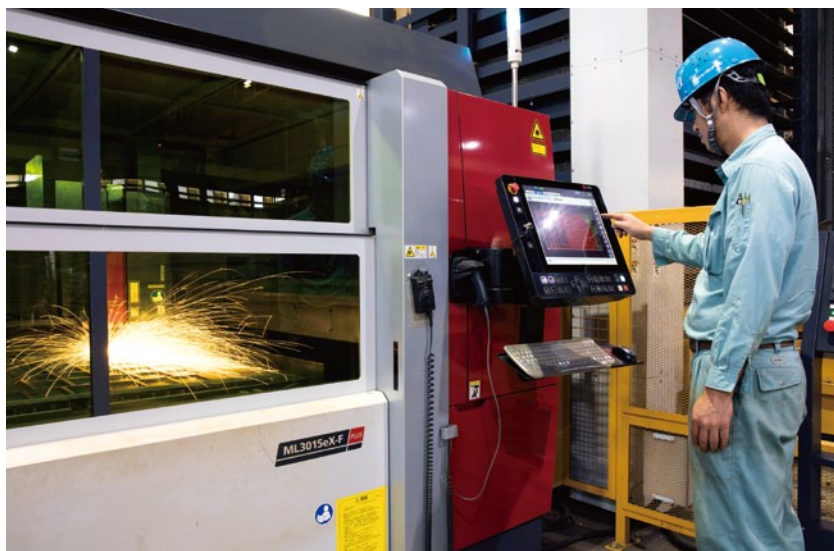
2017年に導入した6kWのファイバレーザ加工機「3015eX-F60」。半年間で稼働時間は約4000時間に及ぶ。
