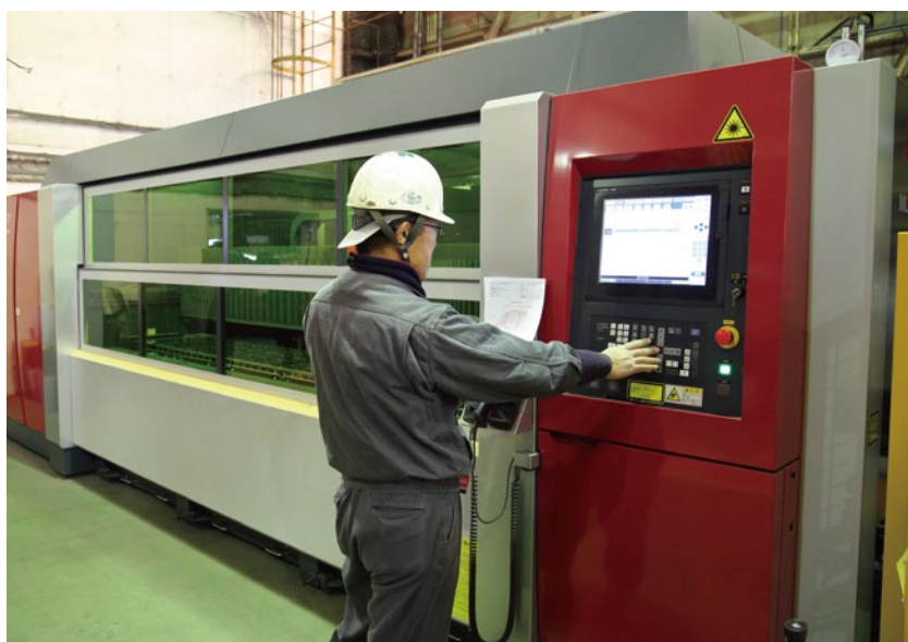
2017年3月に導入した三菱電機の6kWファイバレーザ加工機「ML3015eX-F60」。ズームヘッドを搭載しているため、段取り替え時間を大幅に短縮できる。
