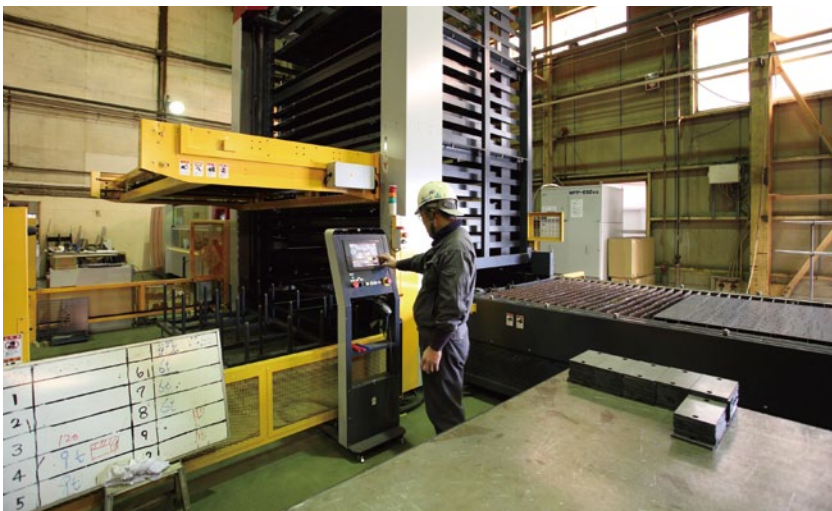
「ML3015eX-F60」とともに導入した15段のストックシステム。鋼板をレーザー加工機に自動供給し、加工が終了すると自動的に搬出する。
