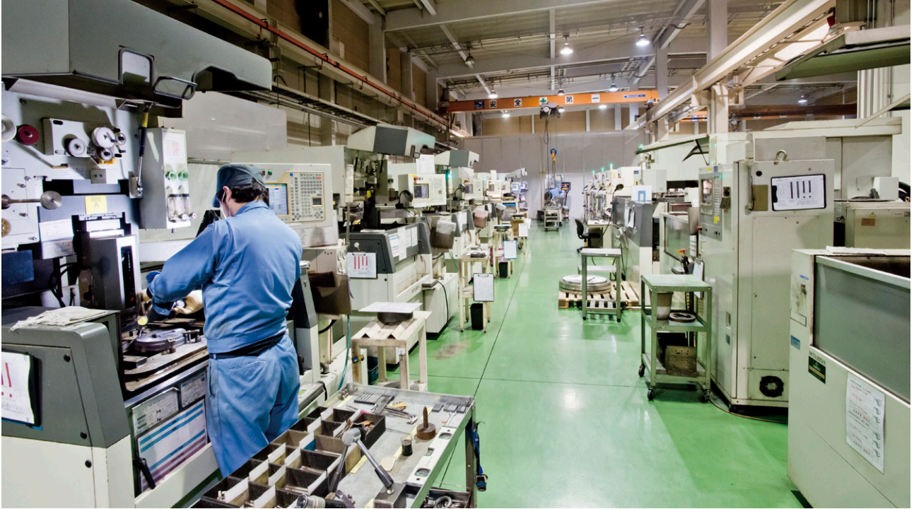
アルミ押出用金型の中核工場である放電精密加工研究所の厚木事業所(神奈川県厚木市)。40台ほどの放電加工機が並んでいる。
