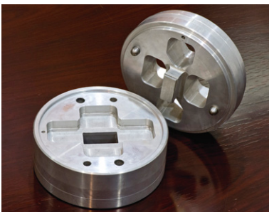
アルミ押出用金型。この金型に5t以上の圧力をかけてアルミサッシの枠を押し出す。
