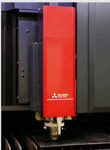
新開発のズームヘッド。三菱電機の他のファイバ二次元レーザ加工機5機種にもオプションとして搭載することができる。
