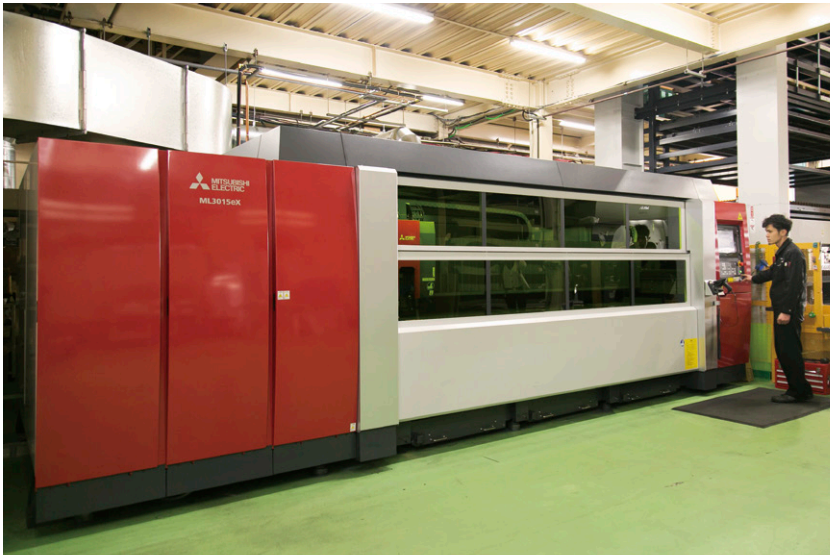
2015年の暮れに導入した三菱電機のファイバ二次元レーザ加工機「eX-F60」。出力は6kWで、CO 2 では切断が難しかった真鍮や銅、アルミニウムなどにも対応できる。
