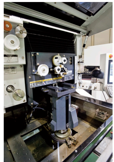
アルミ押出用金型を加工中のワイヤ放電加工機。同金型では同社がトップシェアを握っている。
