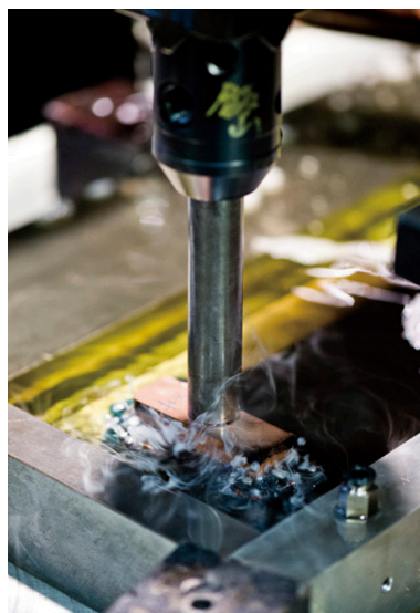
加工中の形彫放電加工機。独自開発した電極や治工具などが高精度加工の秘訣だ。
