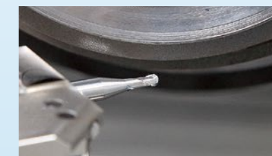
超硬エンドミルは超硬合金製のワーク(写真中央の先のとがった部材)をダイヤモンド砥石(その上)で研削加工して製造する。
