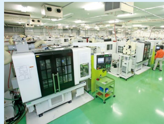
仙台工場の工具研削盤の約6割が、自社開発した「TGM」だ。
