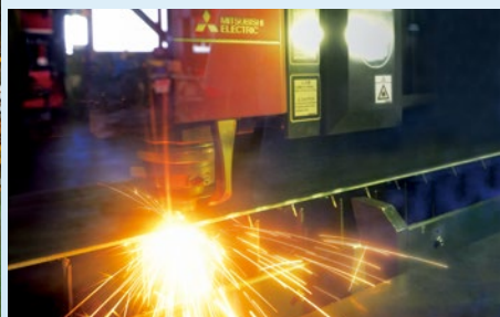
2017年に導入した6kWのファイバレーザ加工機「ML3015eX-F60」。日本初となるツインタワー方式のパレットチェンジャ(10段+12段)を搭載している。
