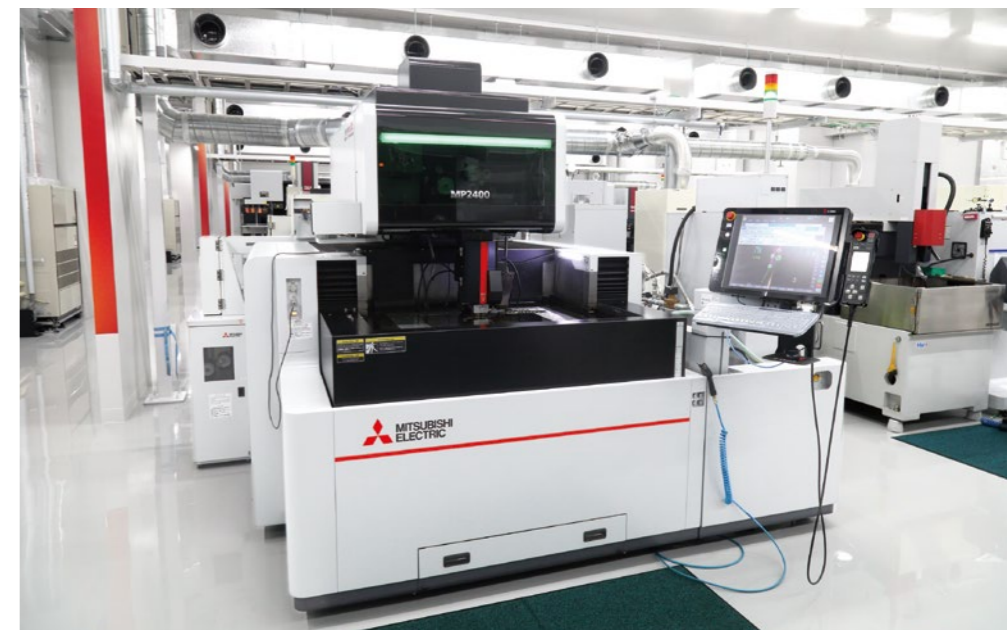
2018年に導入したワイヤ放電加工機「MP2400」。研削盤を使った有人の研削作業のNC化を順次進めている。小柄な女性社員が操作することも多いため、空閑氏は、可能な作業面や操作盤の高さ調整機能が欲しいと述べている。
