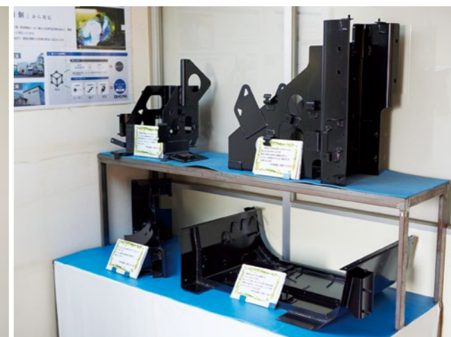
プレス技術の職人技を極めたいと転職してきた加藤学氏も多能工化を目指して勉強中(左)。レーザー加工、曲げ、溶接で複雑に成形された建機用部品(右)。少量多品種化でレーザー加工の出番が増えている。
