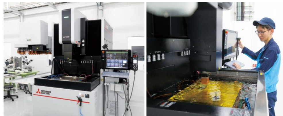
比較的大きな金型を必要とする自動車事業部の要望に応じて導入した形彫放電加工機「SV12PM」(写真左)。既設の「EV12VM」で3日掛かっていた工程が2日で終わることもあり、生産性向上に貢献している。
