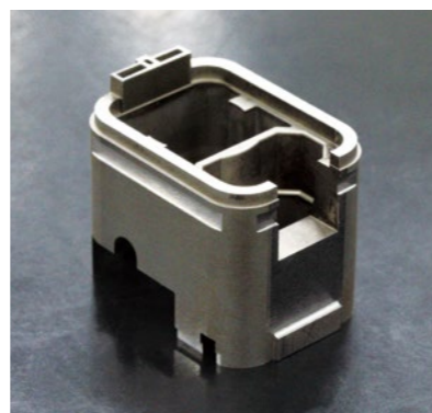
射出成形用金型部品のワークサンプル。ワイヤ加工と放電加工が施されている。
