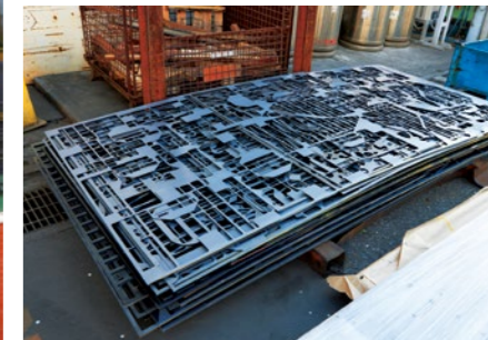
レーザー加工機で部品を切断した後の金属板。自動ネスティングにより部品取りが最適化されている。
