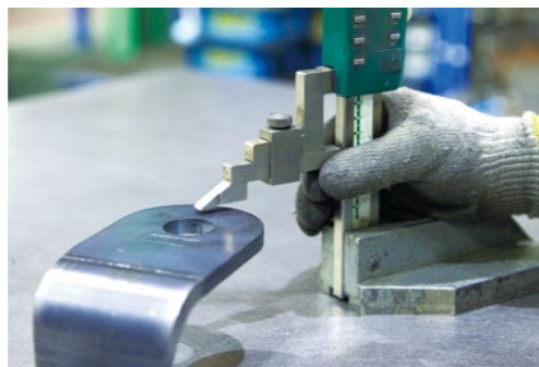
曲げ加工や穴開け加工をした部品の寸法が設計通りになっているか、ハイトゲージで測定している(左)。金属板から無駄なく部品取りするためCADで自動ネスティングする(右)。
