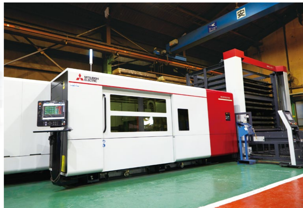
川口工場に導入されている三菱電機のファイバレーザー加工機「ML3015GX-F100」。レーザー加工機に世界で初めて(2019年4月10日発表。当社調べ)AIを搭載し、加工中の音と光から加工状態を判断したり、ノズルを自動で交換したりすることができる。
