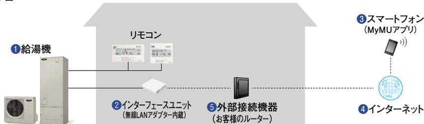
無線LANアダプターは、電気通信事業者(移动通信会社、固定通信会社、インターネットプロバイダ等)の通信回線(公衆無線LANを含む)に直接接続することができません。無線LANアダプターをインターネットに接続する場合は、必ずルーター等を経由し接続してください。
