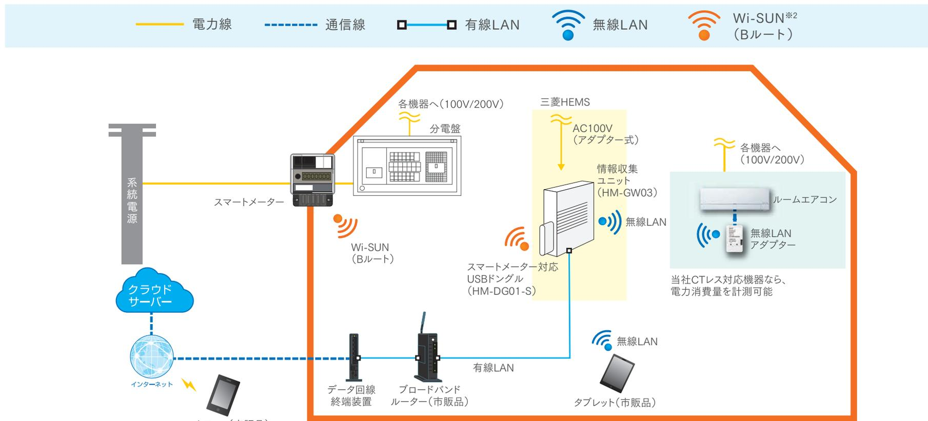
\*本構成例では、実量制の電力料金メニューの使用電力がオーバーする前にお知らせする機能には対応できません。対応するにはエネルギー計測ユニット(HM-EM03)または、計測機能内蔵型分電盤(河村電器産業株式会社)をご使用した構成例が必要です。
