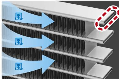
配管形状の扁平化により面積当たりの配管本数を増加させることで、熱交換性能が大幅に向上
