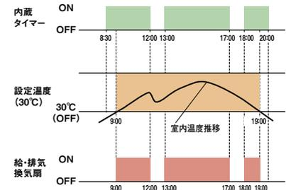
給排気ファンは、内蔵タイマーに従いつつ室内温度が、設定温度よりも高い時間帯に運転します。
