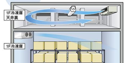
天吊タイプ 0.8馬力なら、背が低く、圧縮機も内蔵。冷媒配管施工なしでラクラク設置できます。
