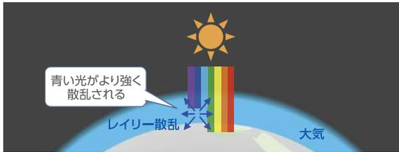
※1:大気圏に太陽光が入射した際に大気を構成している分子によって発生する現象。このとき、波長の短い青い光は波長の長い赤い光よりも強く散乱されるため、昼間に地上から見上げる空が青く見える。
