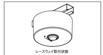
直付形Φ150タイプは電源穴から配線を引き込んで端子台に差込む構造。配線スペースが少ないレースウェイにも露出ボックスなしで取付可能です。
