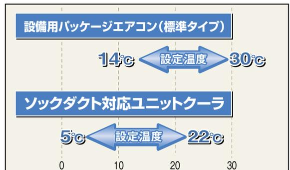
注) +5℃~+10℃で使用の場合、冷却器過霜により露飛びが発生し、ドレンパンで補足できない水がパネルから流れ落ちる恐れがあります。霜取周期時間の設定が必要です。
