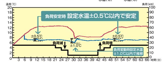
外気35℃、設定水温7℃[出口水温制御]、負荷変動時の水温変化(空冷式10馬力の場合)
