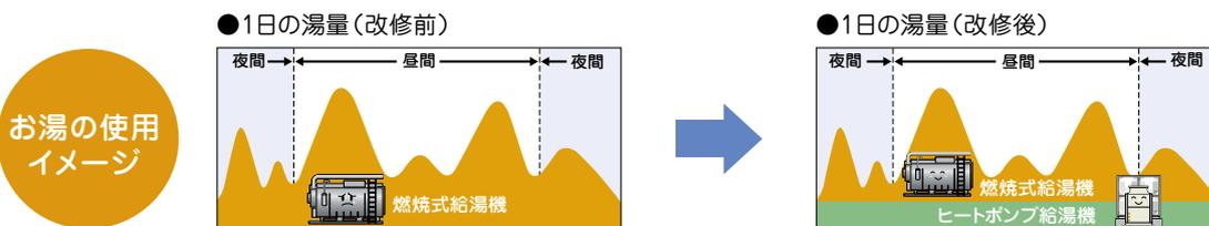
ベースをヒートポンプ給湯機で対応し、負荷変動分を燃焼式給湯機で補うことで、それぞれの特徴を最大限に生かすことができます!
