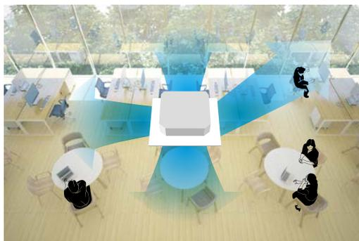
従来の上下ベーンに加え、左右ルーバーユニット(別売)の装着により、気流がいきとどきにくかったエリアにもきちんと風をとどけます。「人感ムーブアイ360」との連動で温度ムラをよりすばやく解消し、風あて/風よけをより細かく制御できます。
