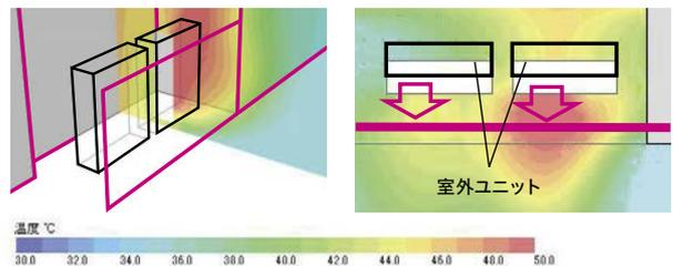
気流解析条件: PUZ-ZRMP140KA11を2台設置、外気温35度、無風状態
