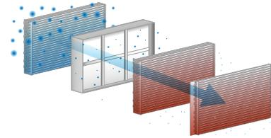
冷却除湿 (冷却コイル)    吸着除湿 (デシカント材)    加熱 (再熱コイル)    加熱 (再熱コイル)
