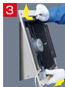
3 窓枠にはめ込んだアルミパネル(お客様手配)に一体化した本体とウェザーカバーを据付ける(アルミパネルを挟み込むように据付ける)。屋内側より固定枠をネジ止める(下側より)。
