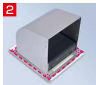
2 同梱の固定金具をウェザーカバーの上下部にあて、本体側からネジ止める。ウェザーカバーと固定枠の隙間(写真内:破線部分)はコーキングで埋める。
