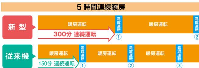
\*従来機PUZ-ZRMP-KA8/ZRP-KA13と新型機PUZ-ZRMP-KA11/KAとの比較。当社試験室(外気温 $-15^{\circ}\text{C}$ )での最大運転時間。外気温条件により、連続運転時間は異なります。
