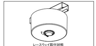
直付形Φ150タイプは電源穴から配線を引き込んで端子台に差込む構造。配線スペースが少ないレースウェイにも露出ボックスなしで取付可能です。
