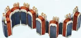
三菱独自の高効率高性能モーター。モーター鉄心を開いてからコイルを巻くことで、高密度巻線を可能にした独自技術を採用しています。
