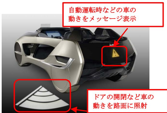
車体に設置したセンサーにより乗員の動きを検知し、ドアの開閉など車の動きが分かる表示デザインを路面に照射します。また、車外に向け、自動運転時などの車の動きをボディライティングで表示することで、他車・歩行者との円滑なコミュニケーションを実現します。
