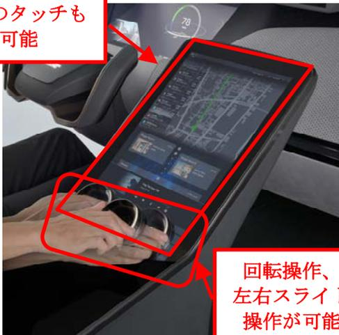
タッチ操作に加え、画面上に取り付けられた左右可動式のノブでも操作できるディスプレイを開発しました。ノブはディスプレイ表示で簡単に機能を変更でき、1 つのノブに複数の機能を集約することで、センターインフォメーションディスプレイ周りのシンプルなレイアウトを実現します。また、ノブは回転操作に加え、左右に動かすことで画面の操作ができるので、手元を見なくても簡単に車載機器を操作できます。
