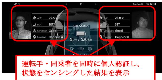
車内中央に設置した1台の広角カメラにより、運転席・助手席搭乗者を同時に個人認証し、双方の状態をセンシングすることができます。これにより、例えば運転手の顔の向きや姿勢などを検知することで、運転ができる状態かどうかを常に確認し、自動運転から手動運転への安全でスムーズな切り替えをサポートします。また、エアコンの温度設定など、乗員の好みや状態に合わせた快適な車室内空間を提供します。
