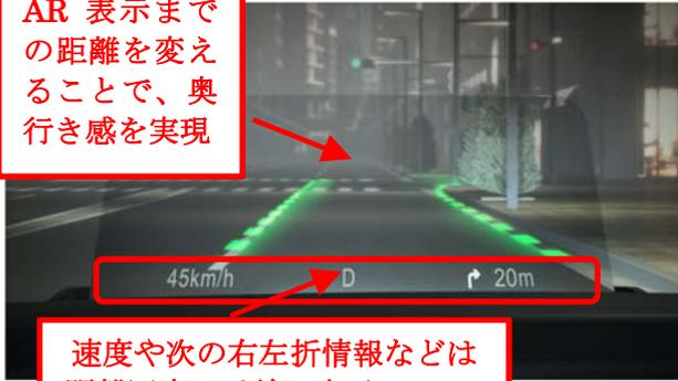
高精度 3 次元地図と高精度測位技術を用いて開発した高精度ロケータとの組み合わせにより、HUD 上に自車が進むべき道路や車線を AR 表示します。これにより、肉眼での道路状況の認識が困難な場合でも、分かり易くルート案内し、安心・安全な走行を支援します。
