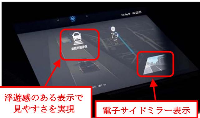
2つの液晶パネルとハーフミラーを用いたクロッシングディスプレイを開発しました。1枚の液晶パネルを斜めに設置し、もう1枚の液晶パネルの虚像を縦面に表示することで、2種類の画像が重なって表示されます。これにより、高い視認性を保ちつつリアルな浮遊感・奥行き感のある表示を実現しました。斜め画面に車両周囲状況などを表示し、縦面の虚像には注意喚起などを見やすく表示することで、安全な走行に貢献します。
