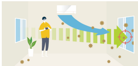
排気窓に向かってエアコンの気流を吹かせる事で換気をアシスト
