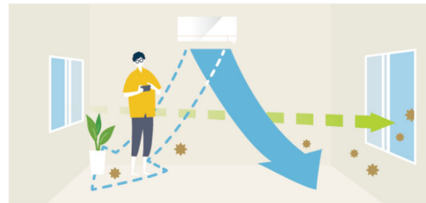
室内の空気を攪拌することで、室内空気の換気残しを抑制
