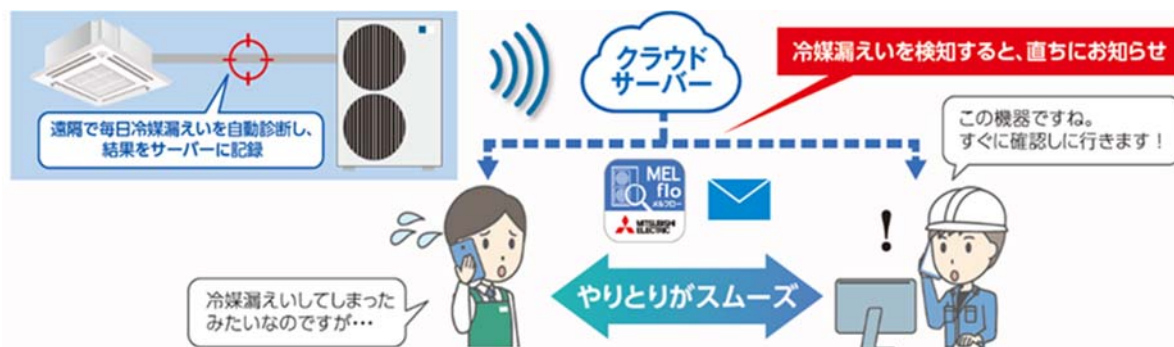
冷媒漏えい検知機能のイメージ
