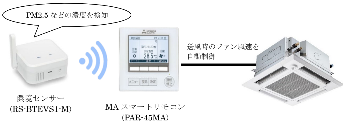
(図3) 4方向天井カセット形<i>-スクエアタイプ</i>と環境センサーの連携イメージ
