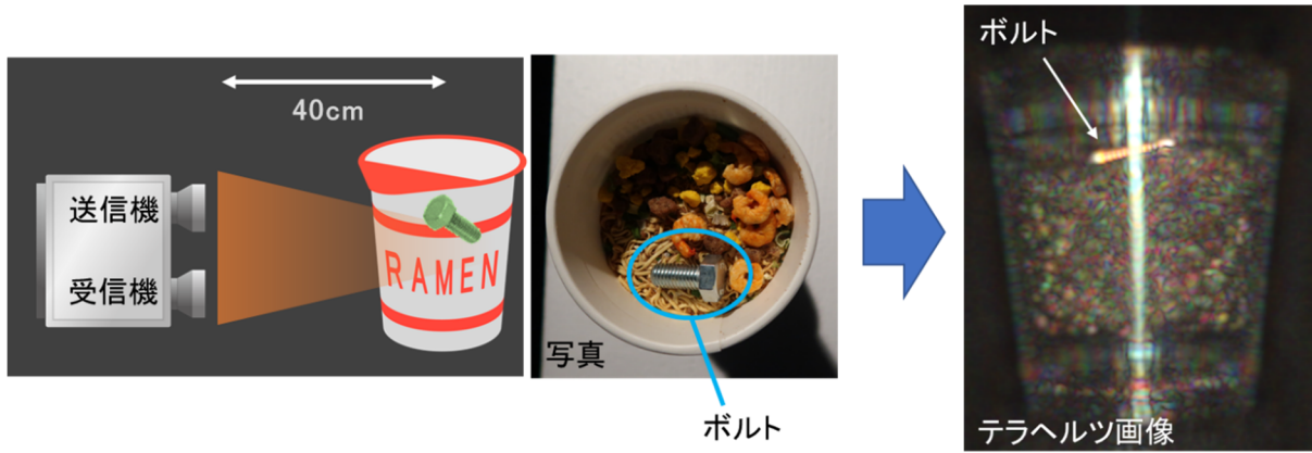
非破壊検査の例（カップめんの中の金属ボルト）
