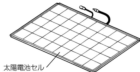
太陽光エネルギーを直流電力に変える働きをします。太陽電池セルが集まり、1枚の太陽電池モジュールになります。太陽電池モジュールの集合体を太陽電池アレイと呼びます。
