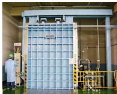
ヘリウムガスを用いた気密試験機
