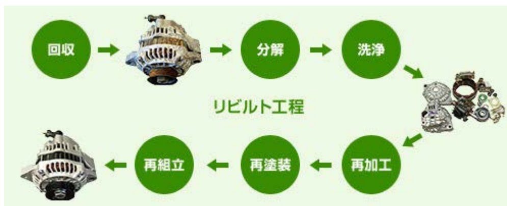
リビルト工程
