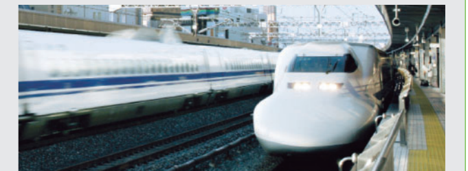
ブレーキ(発電) 加速(電力消費) ブレーキ時に発電した電力は、他の車両の走行のために使われます。
