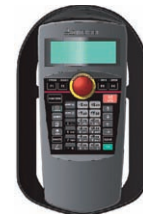
ティーチングボックス
