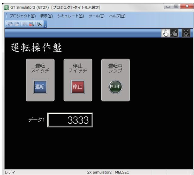
シミュレータが起動して、作画した画面をシミュレートできます。
