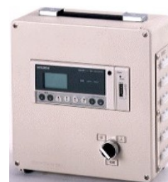
可搬型多回路電力計測ユニット本体外観
