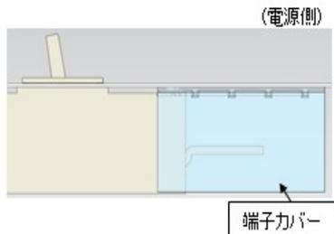
(C)表板を使用せず遮断器表面から十分な離隔を有している場合(58mm以上)
