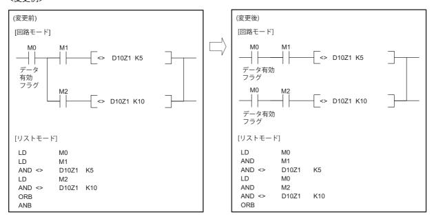
AND<>命令の直前の命令が変更前のプログラム(図左)ではLD命令に変換されていたものが、変更後のプログラム(図右)ではAND命令に変換されます。
