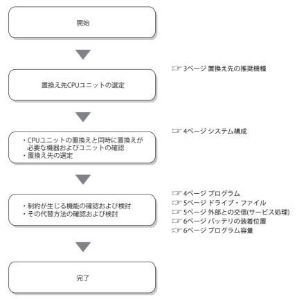
置換え検討時に、 $QnH \rightarrow QnU$ 変換サポートツール $^{*1}$ ので使用を検討ください。 $QnH \rightarrow QnU$ 変換サポートツールは、PCタイプ変更時に下記を本ツール上に表示するため、ユニバーサルモデルQCPUでの置換え検討を効率的に行うことができます。
