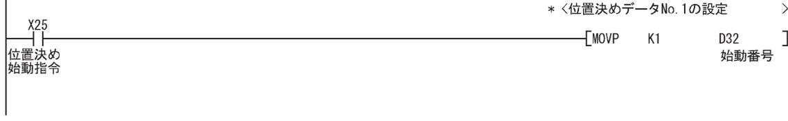
■速度・位置切換え運転始動データNo.の設定(速度・位置切換え運転機能を使用時のみ)
