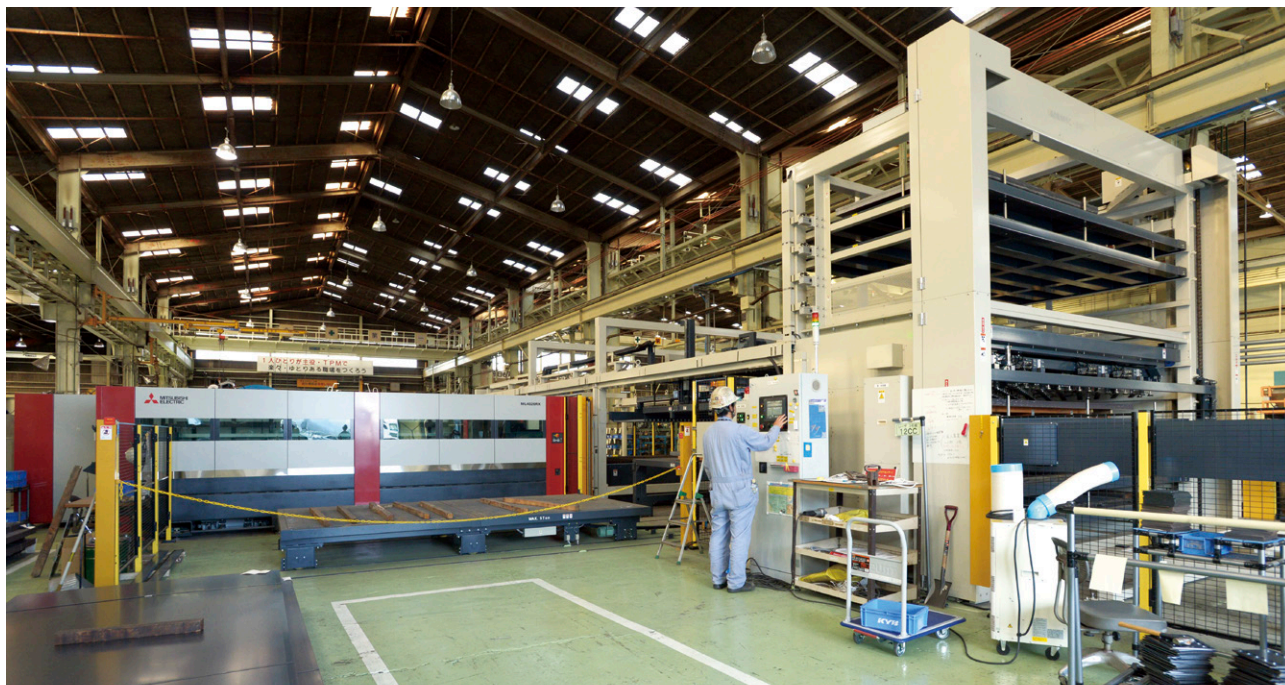
今回導入したレーザー加工機システム。左が「ML4020RX」で、鋼板は右端の収容棚から専用フィーダーでワークエリアに自動搬入される。
