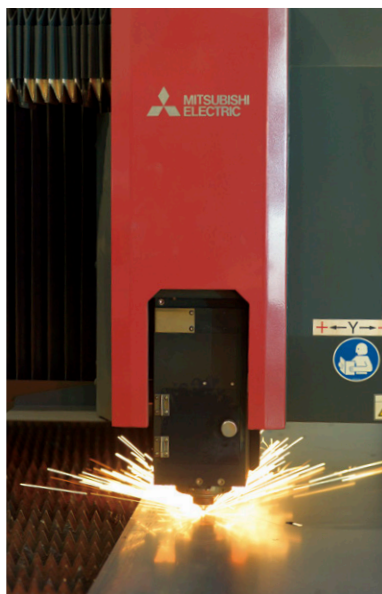
導入したレーザ加工機の出力は4.5kWで、25mmの鋼板まで切断可能だ。
