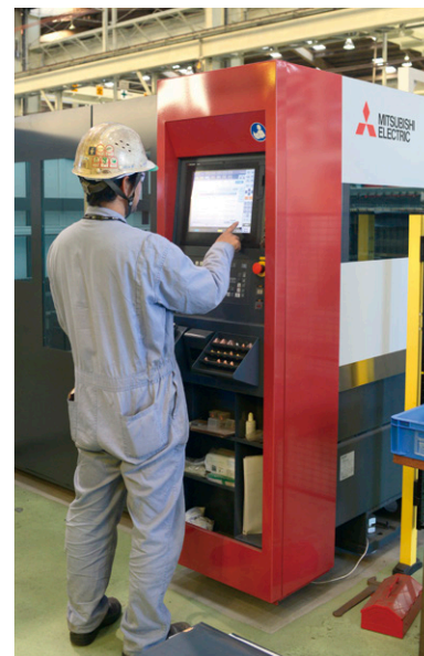
レーザ加工機のCNC装置。従来よりデータの取り込みが容易になったという。
