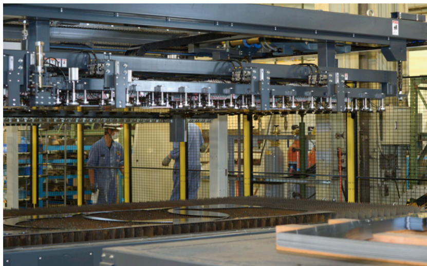
切断後は200個の吸着パッドを使ってすべての部品をパレットに載せる。残った端材は専用のフォークを使って収納棚に自動的に戻ってくる。
