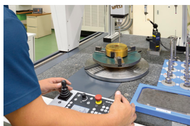
放電加工機で製造した冷間鍛造用金型を三次元測定機で最終検査している様子。
