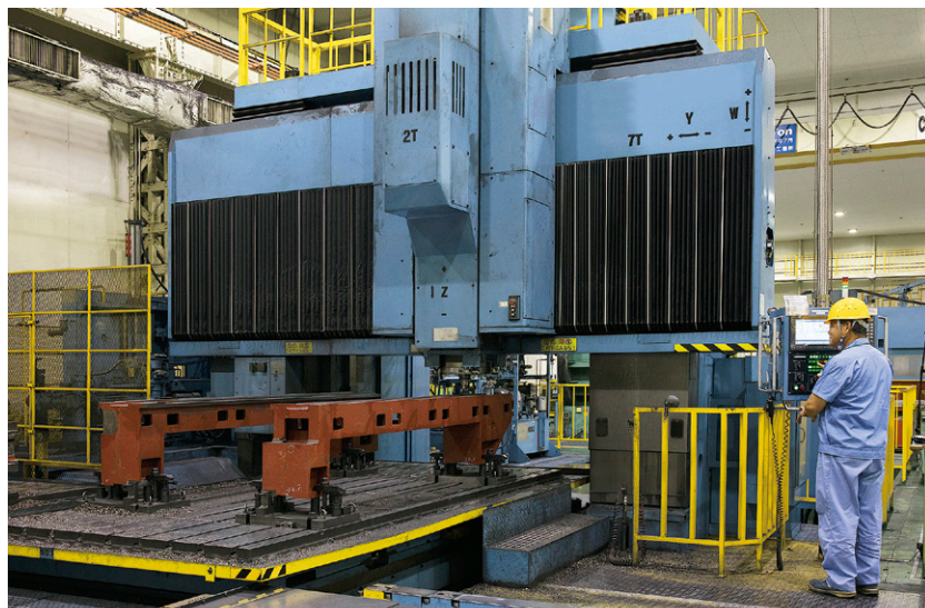
フルオーバーホールを施した五面加工機が稼働している三菱電機名古屋製作所のレーザ製造部の加工現場。
