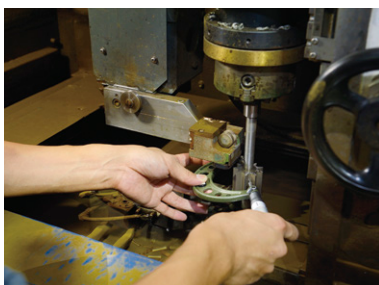
2013年に三菱電機と共同で開発した異型電極製造用のワイヤ放電加工機ロボットシステム。高精度金型製造に威力を発揮する。
