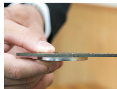
上が酸素、下が窒素の環境下で加工したステンレス。断面の違いがはっきり分かる。
