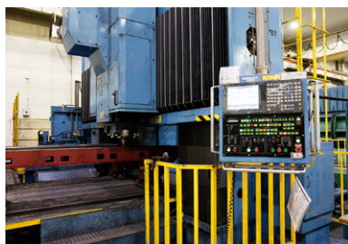
NCも新しい装置にリプレースした。採用したNCは三菱電機の「M700シリーズ」。
