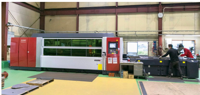
2016年7月に導入した三菱電機のファイバ二次元レーザ加工機「ML3015eX-F40」。出力4kW。
