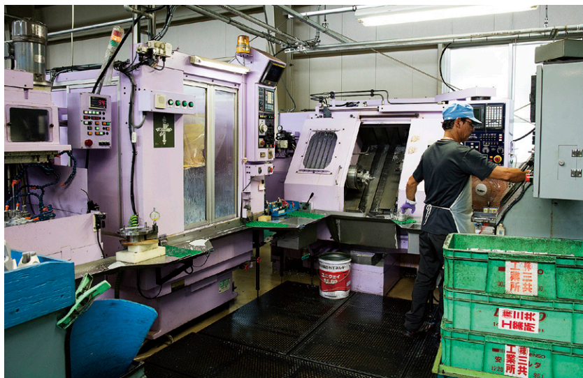
フルオーバーホールを行ったマシニングセンタ(左側の機械)と旋盤(中央)。フルオーバーホールした機械は藤色の塗装を施して搬入する。右の工作機械は、新規購入したものだ。
