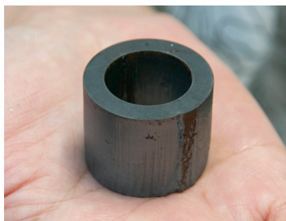
左は25mmの軟鋼の厚板から、レーザでくりぬいた部品。右は1m×1.5m×12mmの厚板に、レーザで直径12mmの穴を5040個開けたもの。
